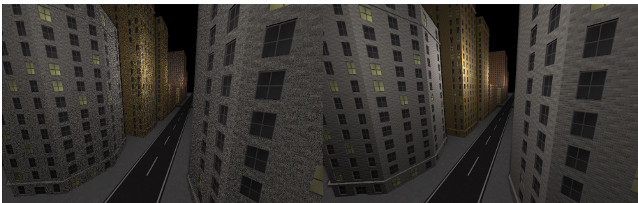
Figura 11: Sulla sinistra: un fotogramma che presenta aliasing sulla texture dei mattoni. Il filtraggio non corretto del campionamento delle normali alla superficie crea il disturbo. Sulla destra: lo stesso fotogramma con un filtraggio adeguato.
